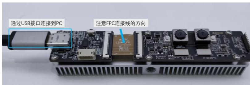
图 2.2 连接 VisionSeed 到电脑 USB 接口
